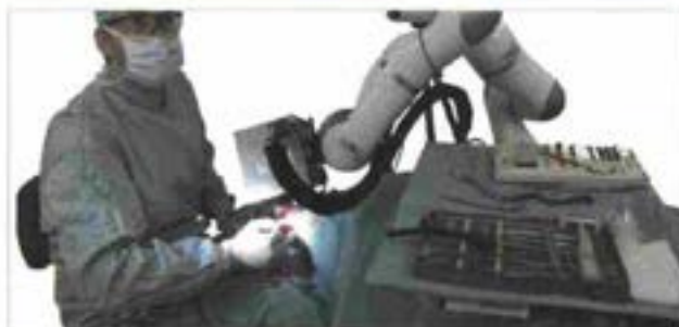
Il robot CARLO (Computer Assisted Robot-guided Laser Osteotome) è uno dei primi esemplari di robot per sala operatoria. (Foto: AOT AG Basel)
