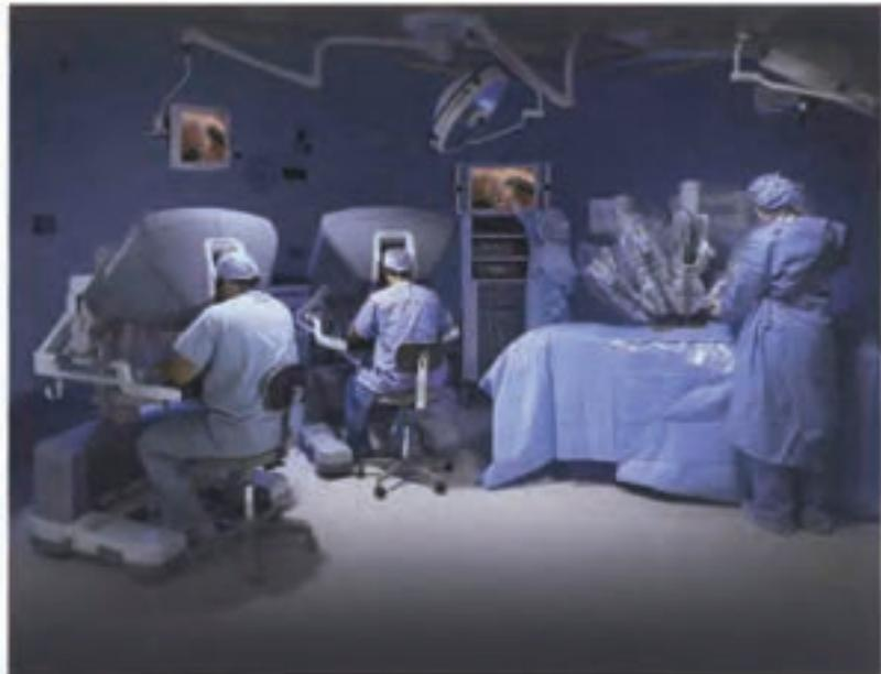
**IL ROBOT DA VINCI È UNA PIATTAFORMA EVOLUTA PER LA CHIRURGIA MININVASIVA. PERMETTE AL CHIRURGO DI ESEGUIRE INTERVENTI COMPLESSI GRAZIE ALL'INTEGRAZIONE DI UNA VISIONE 3D AD ALTA DEFINIZIONE CON LA STRUMENTAZIONE ENDOWRIST E IL SISTEMA INTUITIVO DI CONTROLLO DEGLI STRUMENTI.**
