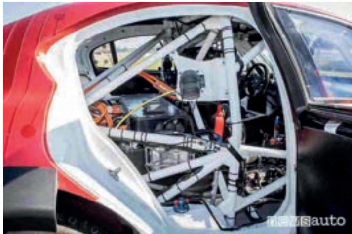
Roll-bar, vano per la ricarica della Giulia ETCR by Romeo Ferraris
