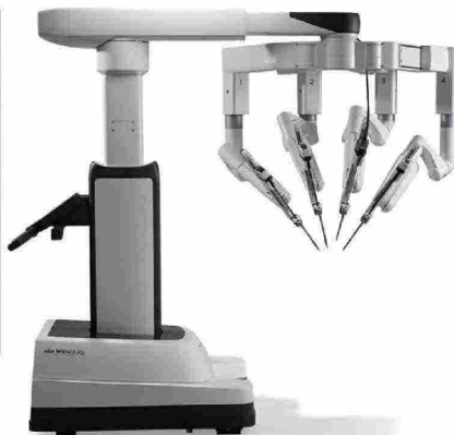
Il carrello del sistema Vinci X è dotato di quattro bracci robotici che offrono ampia libertà di movimento e una rotazione di circa 540°
