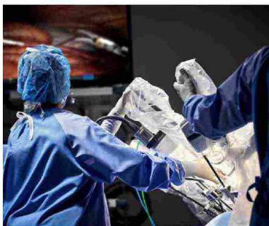
Il carrello del sistema Vinci X è dotato di quattro bracci robotici che offrono ampia libertà di movimento e una rotazione di circa 540°
